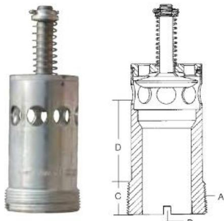
Предназначены для монтажа во фланцевых соединениях с внутренней резьбой в нижней части резервуара для наполнения, отвода или уравнивания давления. Обеспечивают высокую пропускную способность и малый перепад давления для минимизации кавитации перед насосом. При применении в подъемных трупопроводах газообразной фазы минимальный внутренний диаметр стояка должен быть по крайней мере в два раза больше размера резьбы клапана, чтобы не нарушать поток газа из боковых входных отверстий.
