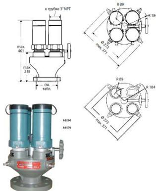
Предназначены специально для использования в качестве первичного предохранительного клапана на больших стационарных резервуарах под давлением с фланцевыми соединениями. Клапаны Multiport™ имеют резервный предохранительный клапан, обеспечивая обслуживание или замену любого предохранительного клапана без остановки эксплуатации.
