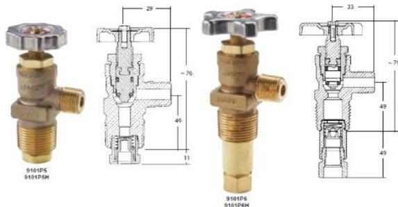
Встроенный скоростной клапан, присутствующий во всех этих клапанах для отбора СУГ, помогает предотвратить порчу продукта в случае разрыва газового трубопровода. При необходимости отбора жидкой фазы серия 9101P6 имеет возможность непосредственного присоединения к газопроводу. Клапаны серии 9101P5 должны устанавливаться в резервуарах, имеющих отдельную оснастку для отвода жидкой фазы.
