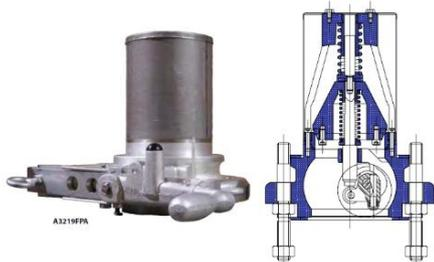
Предназначены для работы со сжиженным газом и безводным аммиаком в транспортных резервуарах высокого давления и стационарных резервуарах. Установка простая и легкая, подходит для большинства существующих резервуарных фланцев. Клапан можно запускать вручную или пневматически. Дистанционный контроль A3219RTc этим клапаном обеспечивает возможность дистанционного управления вместе с термозащитой.
