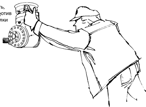
Рисунок 9. Приведение в действие фланцевого клапана Flomatic® вручную
